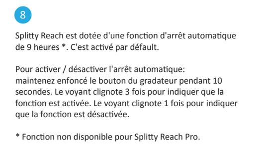
Splitty Reach est dotée d'une fonction d'arrêt automatique de 9 heures\*. C'est activé par défaut.
