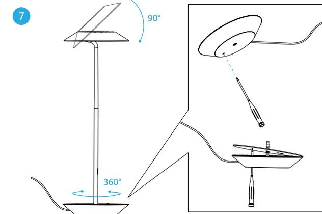
**En option:** Pour changer la plaque de couverture, débranchez l'adaptateur, dévissez le corps de la lampe, puis utilisez un tournevis ou un objet long et étroit pour percer le trou au bas de la base et poussez le couvercle vers le haut. Répétez l'étape 2.
